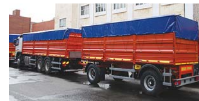
Маса автомобіля складає – 8 500 кг, повна маса (тобто маса, яку може перевозити транспортний засіб) – 33 000 кг, маса причепа – 2 750 кг, повна маса (тобто маса, яку може перевозити транспортний засіб) – 18 000 кг
