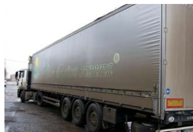
Маса автомобіля складає – 6 700 кг, маса причепа – 6 900 кг, повна маса (тобто маса, яку може перевозити транспортний засіб) – 35 000 кг
