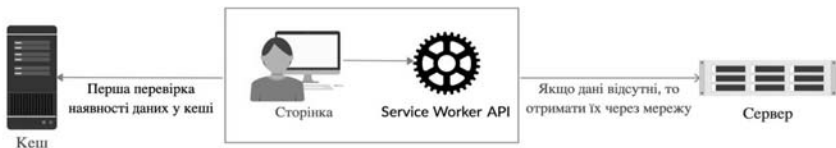
Рис. 2. Спрощена схема взаємодії Service Worker із сервером і кешем
